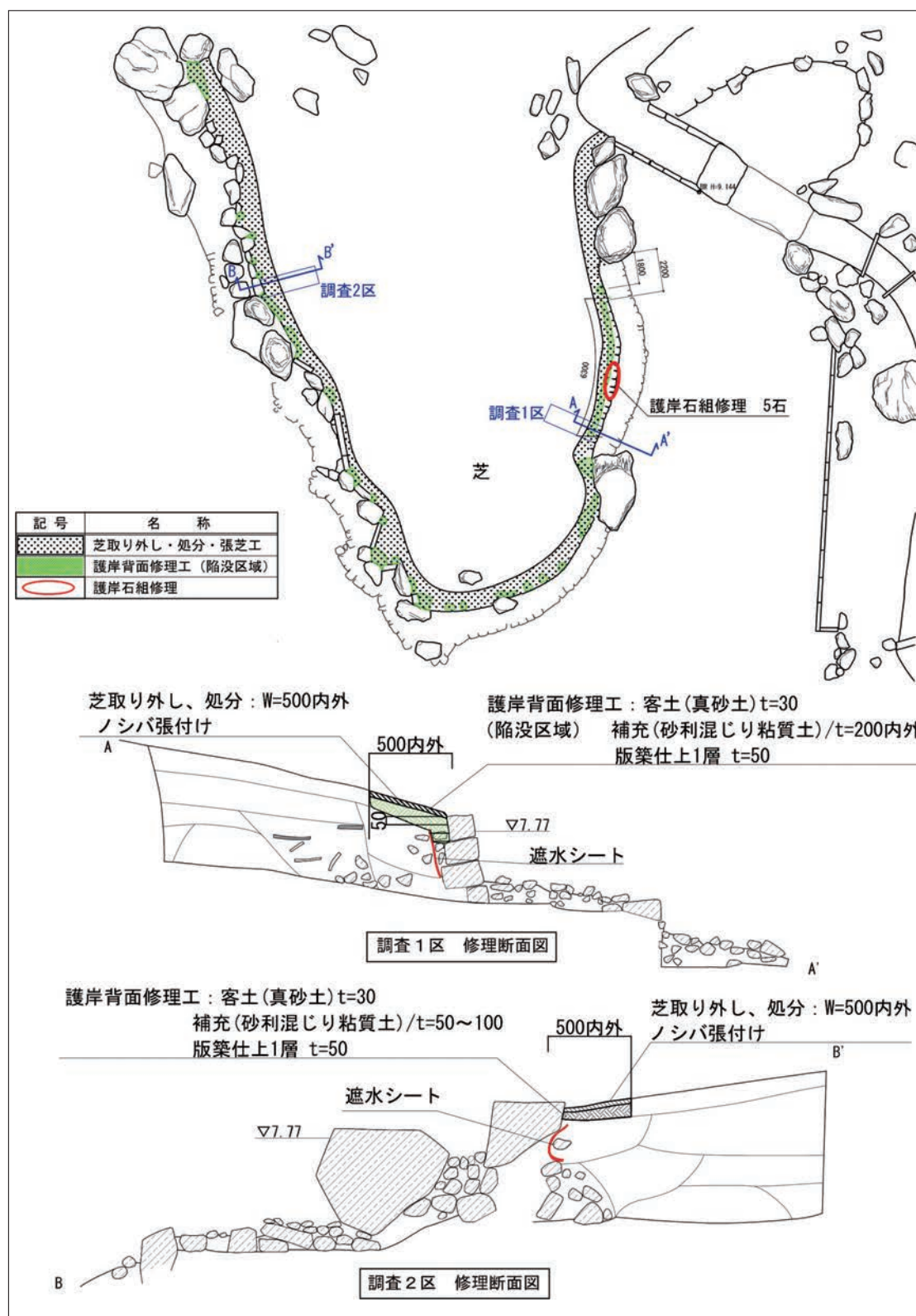
図12 出島護岸補修図
