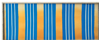
図29 清涼殿障壁画紺青引試験手板(試験後)
